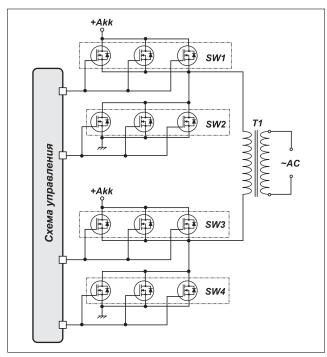
Рис. 4. Параллельное включение транзисторов инвертора
