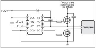
Рис. 7. Типовой вариант включения микросхемы IR2101
