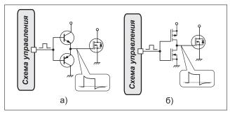
Рис. 5. Двухтактные комплементарные выходные каскады управляющей схемы для управления MOSFET-транзисторами
