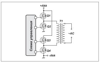
Рис. 1. Эквивалентная схема инвертора ИБП
