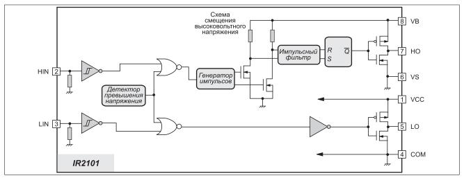
Рис. 8. Функциональная блок-схема IR2101
