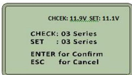
1. Находясь в режиме основного меню или когда активирован интерфейс заряда/разряда возможно запустить процесс зарядки/разрядки удерживанием клавиши "Enter". При этом параметры процесса заряда/разряда будут соответствовать установленным параметрам.
