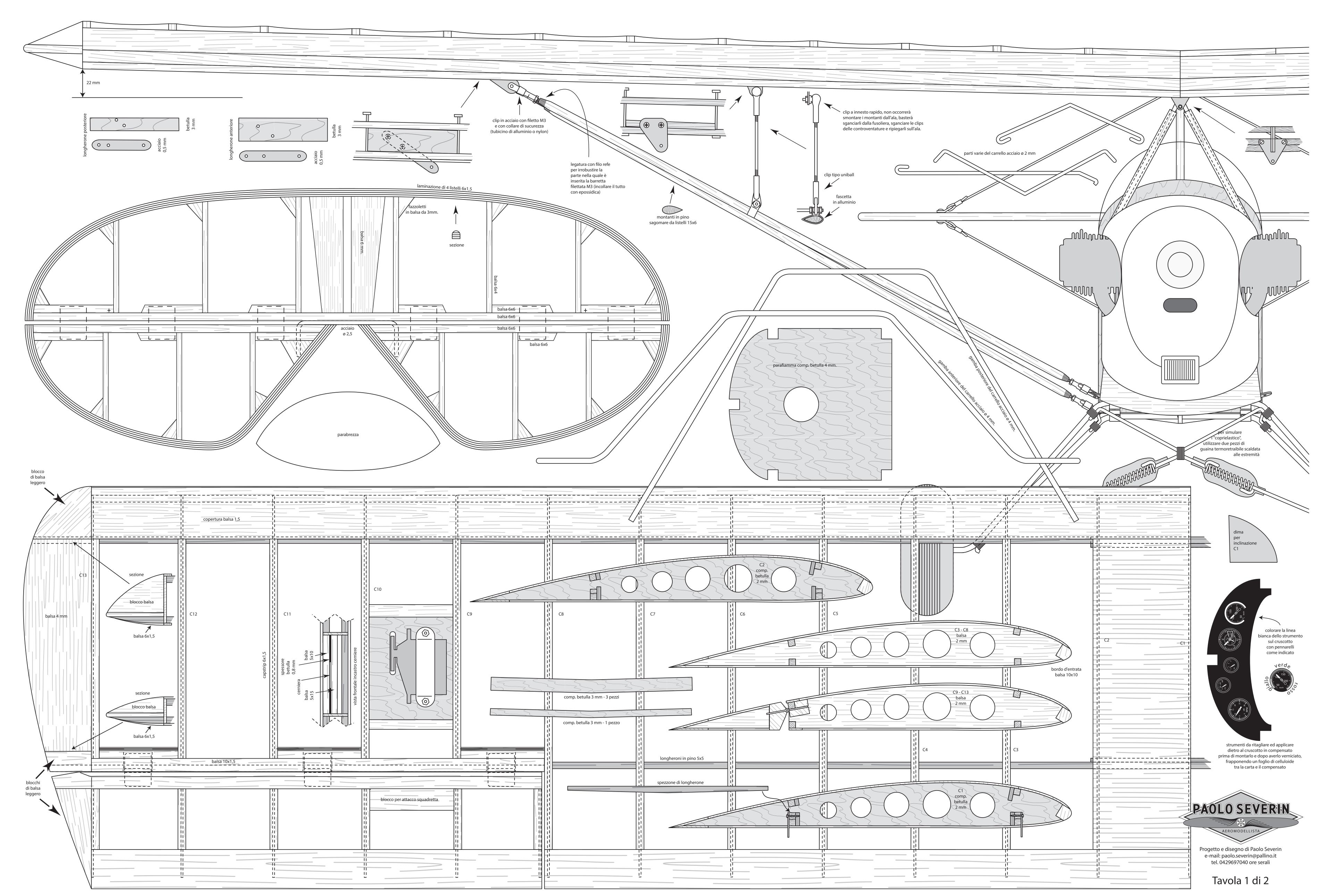
Baby Ace • Riproduzione RC scala 1:4,4 • Apertura alare 178 cm. • Lunghezza 120 cm. • Peso 3 kg. • Carico alare 55 g/mq • Motorizzazione 8 - 13 cc. 4T, 7,5 - 10 cc. 2T
