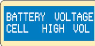
Напряжение ячейки слишком высокое, проверьте напряжение каждой ячейки.
