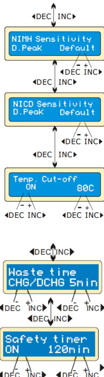
Здесь показано пороговое напряжение для автоматического останова зарядки NiMH и NiCd батарей. Эффективное значение варьируется от 5 до 20mV на ячейку. Если установить значение порогового напряжения выше, существует опасность перезаряда батарей; если значение установить ниже – будет существовать возможность преждевременного отключения. Данные значения необходимо уточнить по техническим характеристикам батарей. (NiCd по умолчанию: 12mV, NiMH по умолчанию: 7mV)
