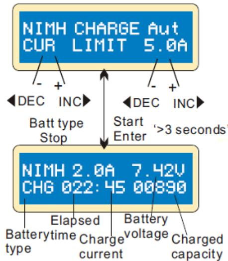
Эта программа используется для зарядки NiCd/NiMH батарей, применяемых в радиоуправляемых моделях. Пользователь может нажать кнопку **START/ENTER**, при этом значение будет мигать на дисплее. Нажатием кнопок **INC** или **DEC** изменяются значения параметра.
