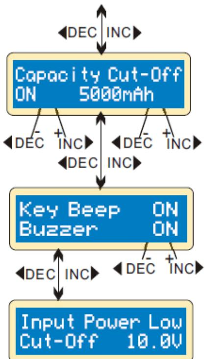
Программа обеспечивает функцию защиты батареи по максимальной емкости. Если Дельта пикового напряжение не может быть определено и не вышло время сработки таймера, процесс зарядки остановится автоматически при достижении максимальной емкости заряда, установленной пользователем.
