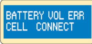
Ошибка соединения, проверьте целостность разъема и проводов.
