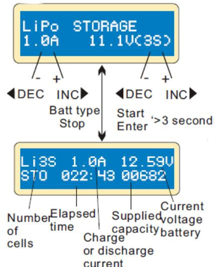
На этом дисплее пользователь может установить ток и напряжение батарейной сборки. Зарядка и разрядка в режиме хранения **Storage** устанавливает уровень напряжения батареи для режима хранения.
