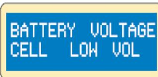
Напряжение ячейки слишком низкое, проверьте напряжение каждой ячейки.
