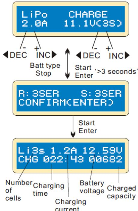
Левая сторона первой линии показывает выбранный тип батареи. Значение во второй линии дисплея показывает установленный ток. После выбора тока и напряжения нажмите и удерживайте более 3-х секунд кнопку **START/ENTER** для запуска процесса заряда. (Зарядный ток: 0.1-5.0A, напряжение: 3.7-22.2В).
