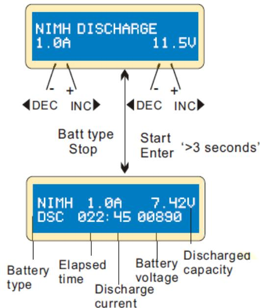
Установите разрядный ток в левой части дисплея и конечное напряжение в правой части. Диапазон тока устанавливается в пределах 0.1-1.0А; напряжения в пределах 0.1-25.0В. Нажмите и удерживайте более 3-х секунд кнопку **START/ENTER** для запуска программы.
