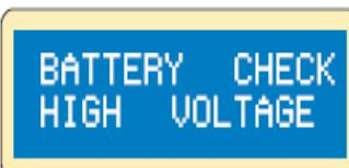
Напряжение больше установленного. Проверьте количество ячеек.
