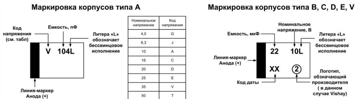
Рисунок 10 – Маркировка танталовых чип-конденсаторов Vishay
